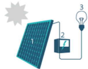
1. Zonnepaneel | 2. Omvormer | 3. Elektrische toestellen
